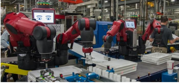
Un exemple de robot collaboratif (Baxter) déployé dans une usine. 3
